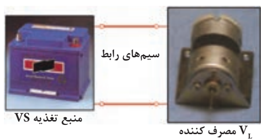
شکل ۵-۹۶ افت ولتاژ بین مولد و مصرف کننده
