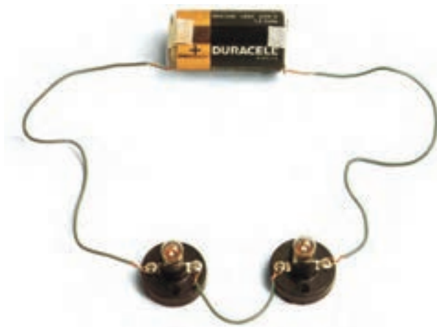
شکل ۵-۳- مدار واقعی دو لامپ به صورت سری
