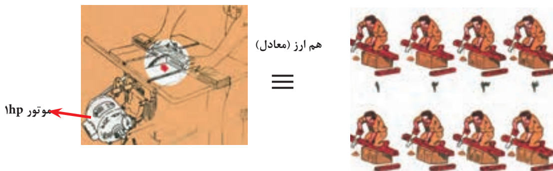
شکل ۹-۶- مقایسه قدرت موتور یک اسب بخار با توان انسان.
